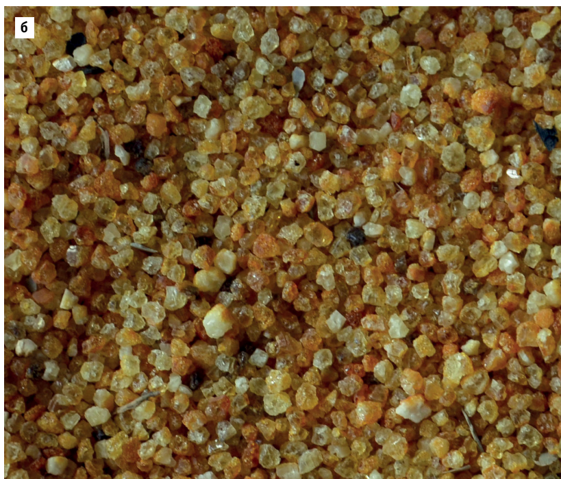
Рис. 5. Янтарь после обработки на установке ЭГДЛ-10: а) Очищенный янтарь и янтарь до обработки; б) класс крупности -5+2,5 мм
