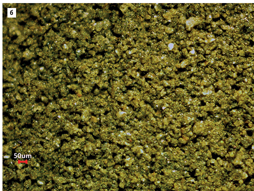
Рис. 3. Шлам марганцевой руды после обработки на установке ЭГДЛ-10: а) класс крупности -0,63+0,16 мм; б) класс крупности -0,05 мм
